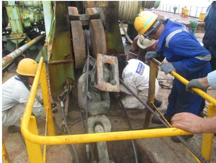
Gambar 6.4 Proses Memasukkan Rantai Jangkar ( Bitter end ) kedalam chain locker
