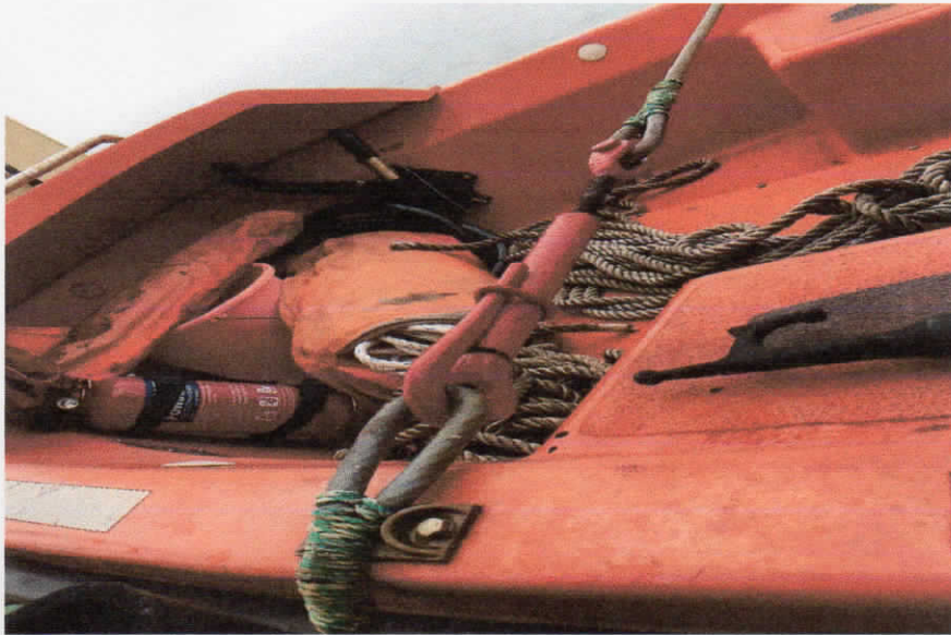
LAMPIRAN 8 SEKOCI EQUIPMENT Tidak Tertata Pada Tempatnya
