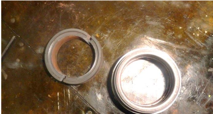
Kerusakan pada mechanical seal
