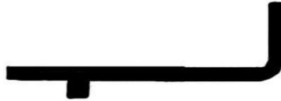
Gambar 2.4. Deck Pin atau Deck Locking Pin
