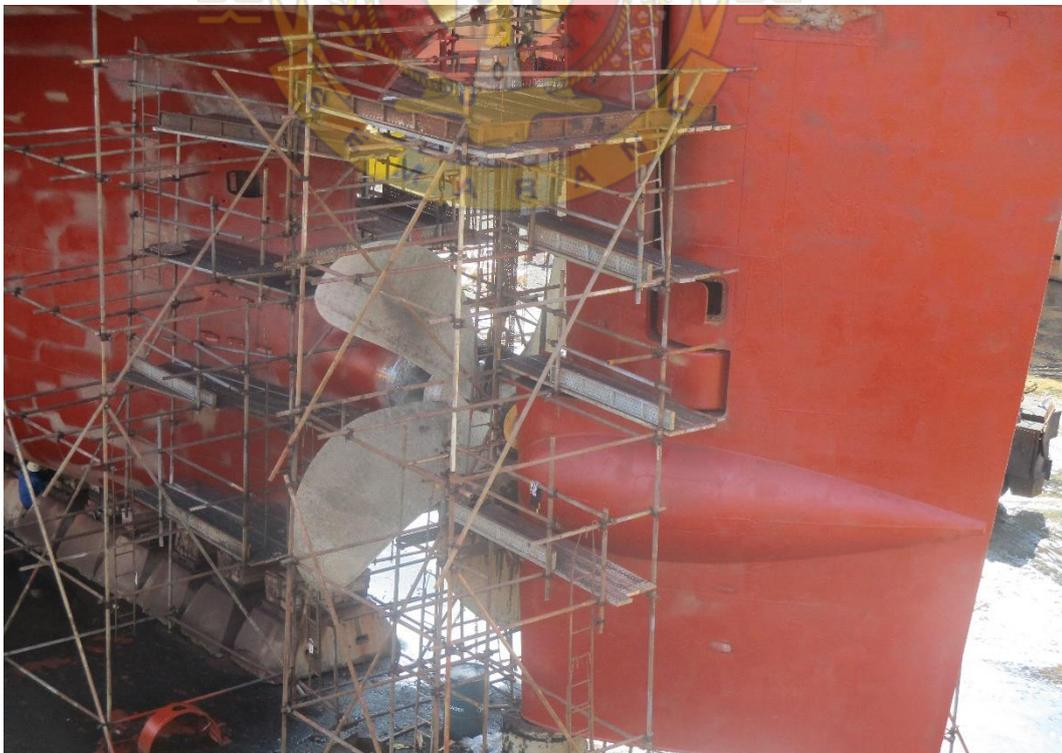
Pemasangan *stagger* untuk pemeriksaan *propeller*
