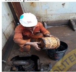
Sumber dari dokumen KM. Armada Papua Gambar 4 Perawatan got palka
