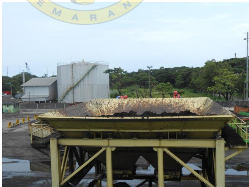
**Gambar 2.3: Hover/feeder di Pelabuhan Tanjung Intan Cilacap**
