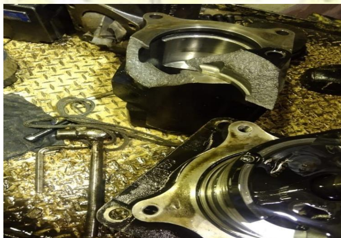
Housing pada pompa pecah
