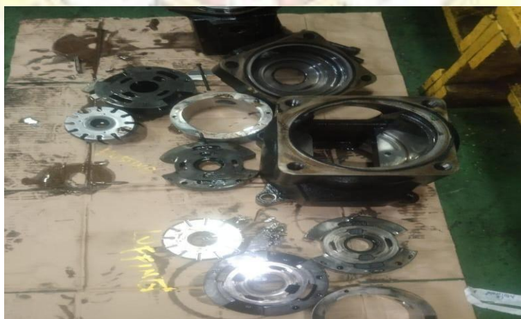
Proses Overhaul pompa hidrolik
