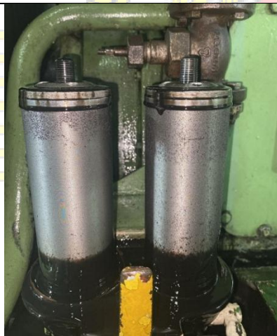
Penemuan partikel logam di filter
