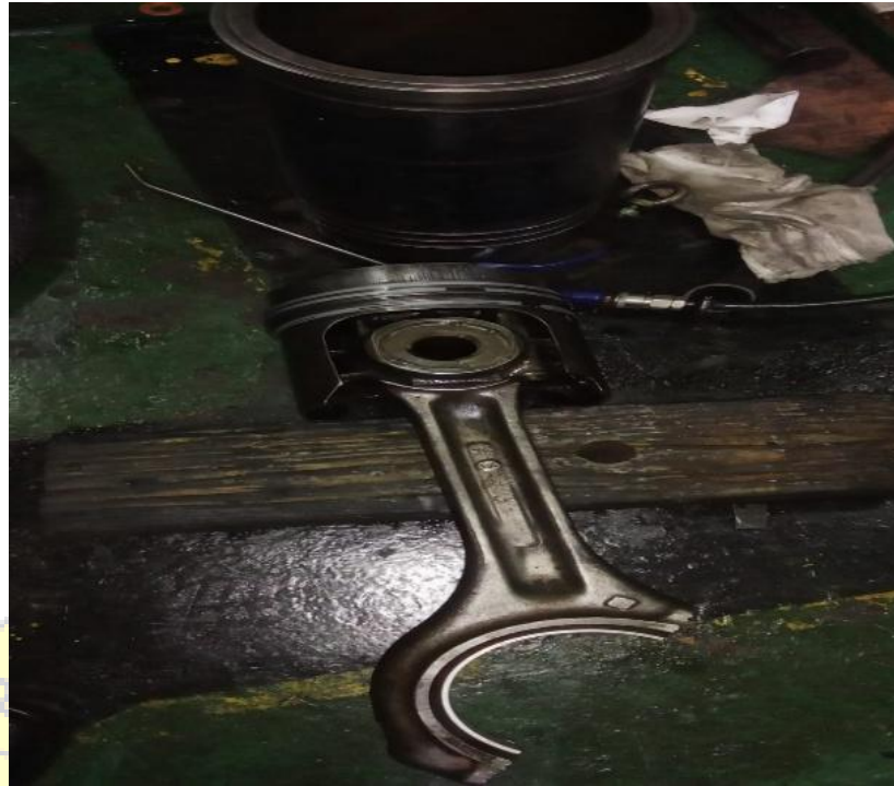
Gambar 2.3 Piston Diesel Generator Sumber : Dokumen Pribadi 2025
