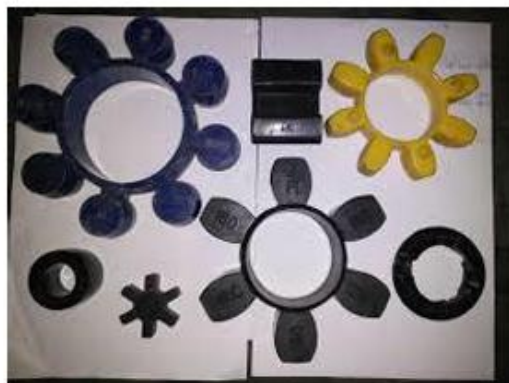
Gambar 2. 10 Rubber coupling Sumber : Haris et al., (2024)
