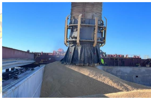
Gambar 2. 2 Loading gandum menggunakan conveyor belt Sumber: Dokumen Penelitian (2024)
