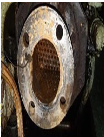
Gambar cover tube L.O cooler setelah di bersihkan
