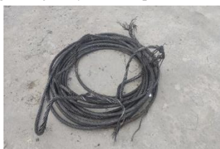
Gambar 3 : Crane wire yang putus
