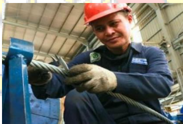
Gambar 4 : Pengecekan dan pemeliharaan crane wire
