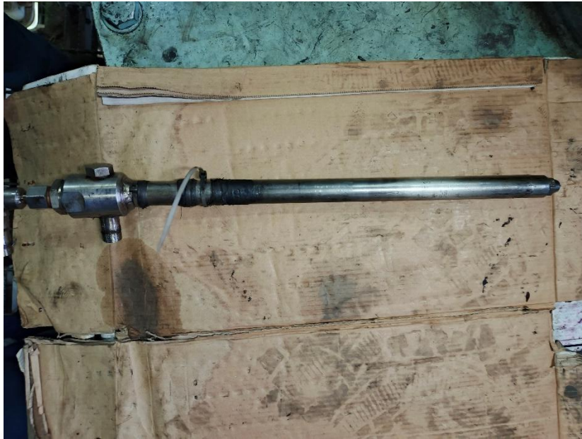
Gambar 4. 28. Kondisi Main Burner Setelah Dibersihkan
