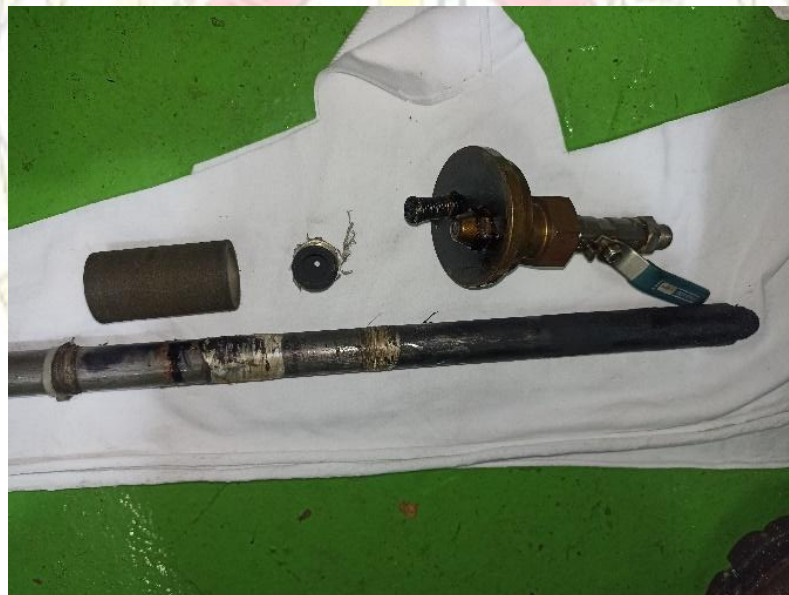
Gambar 4. 27. Kondisi Ignition dan Main Burner Sebelum Dibersihkan
