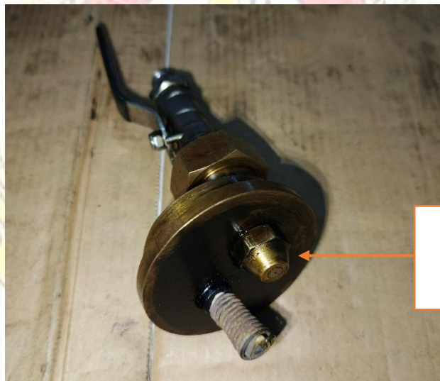
Gambar 4. 29. Kondisi Ignition burner Setelah Dibersihkan
