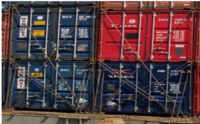
Gambar Lam.3 Lashing condition dilihat dari Hatch Cover .
