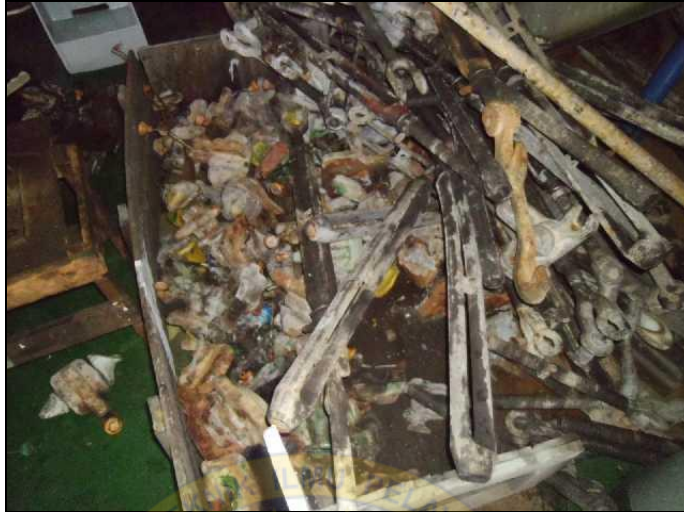
Gambar Lam.6 Lashing Gears yang rusak disisihkan.
