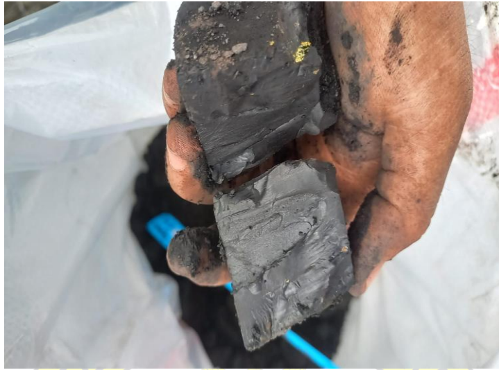
Gambar 2.3 Batubara Bituminus Sumber: Dokumentasi Pribadi (2024)
