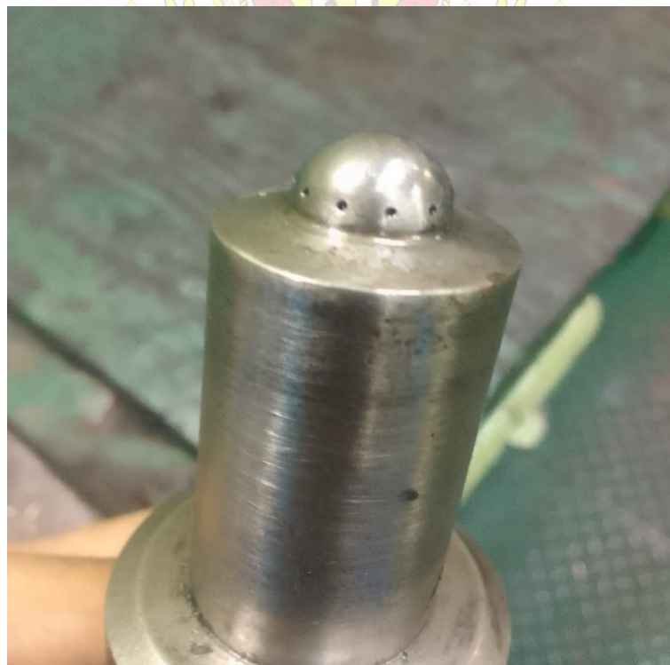
Lampiran 8 Kondisi nozzle setelah dibersihkan dan skir
