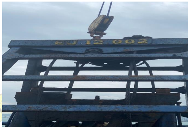
Gambar 2. 5 Wipe Rope Hydraulic Grab (Sumber: Dokumentasi Pribadi (2024))
