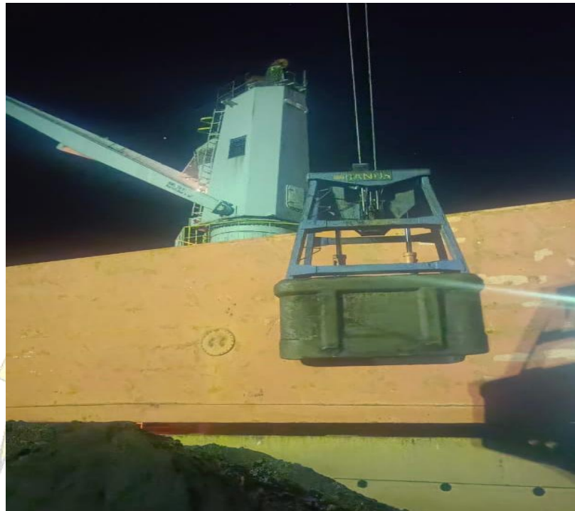
Gambar 2.1 Hydraulic Grab Sumber: Dokumentasi Pribadi (2024)
