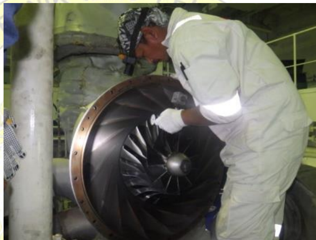
Gambar 4. 13 Gambar blower side jammed Sumber: Dokumentasi pribadi
