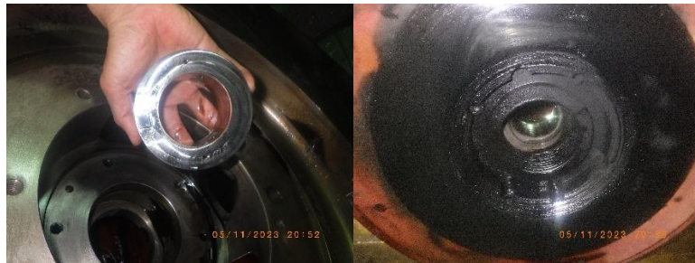
Gambar 4. 8 Gambar bearing yang aus dan gambar labyrinth packing yang terkikis
