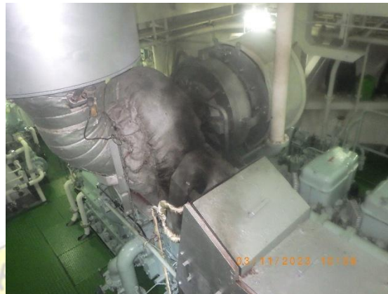
Gambar 4. 11 Gambar keadaan TC yang mengeluarkan asap Sumber: Dokumentasi pribadi
