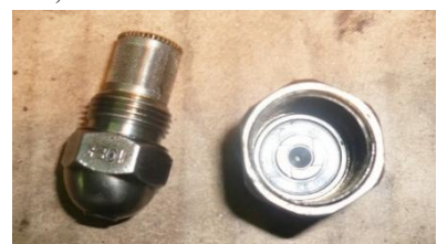
Gambar 3. Nozzle pada main burner
