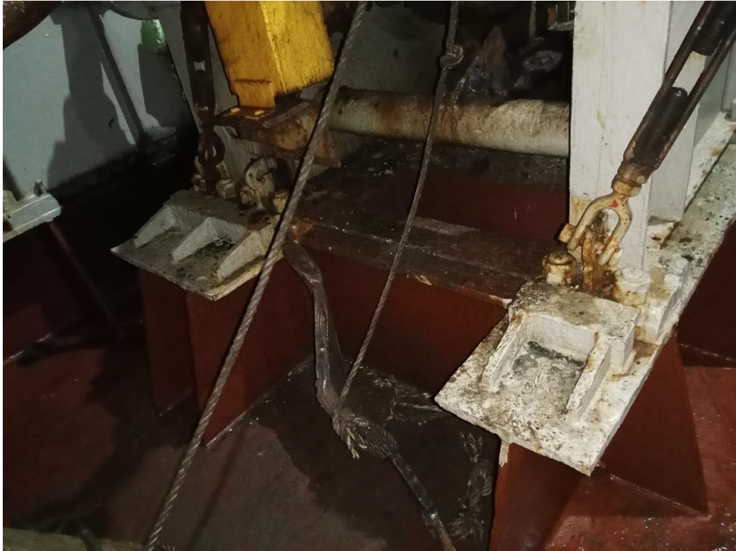
Lampiran 9 Kerusakan lidah jangkar
