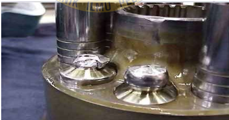
Gambar Kerusakan Piston Pompa
