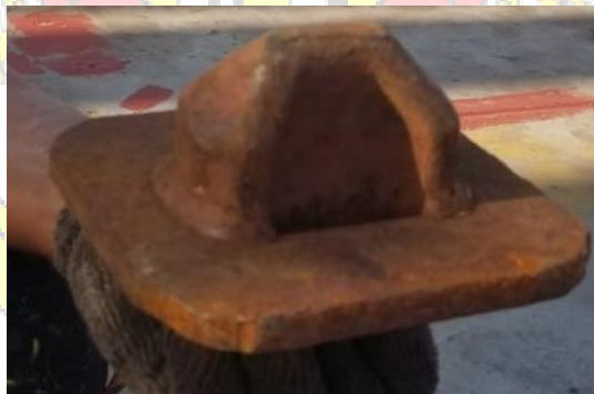
Gambar 2.2 Staking Cone Sumber : Dokumentasi Peneliti
