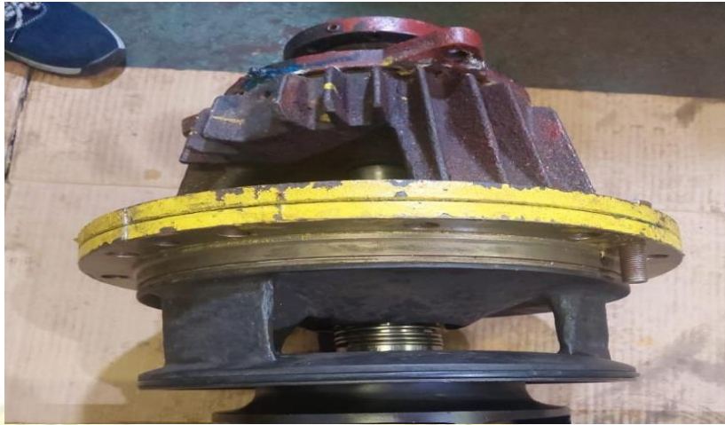
Gambar 2.6 Rumah pompa pada cargo oil pump
