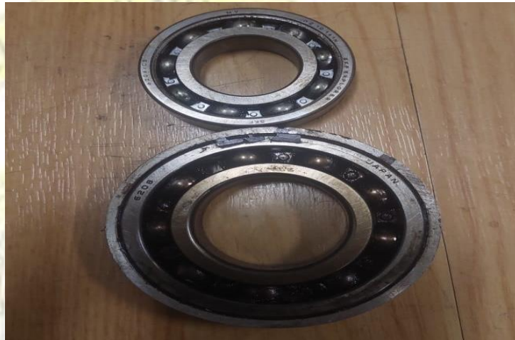
Gambar 2.2 Bearing pada cargo oil Sumber: Dokumen Peneliti (2023)
