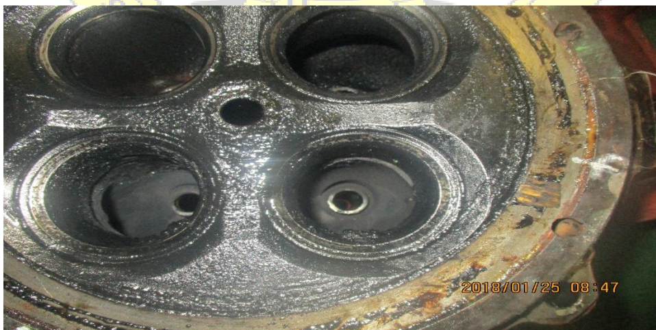
Gambar Cylinder Head Exhaust Valve Yang Bocor
