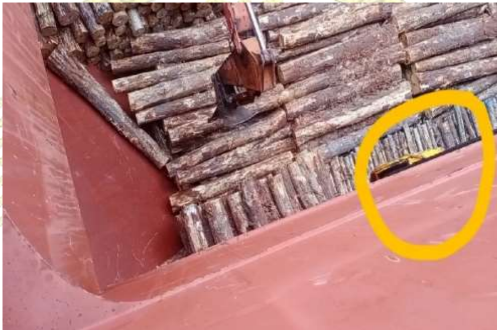
Gambar 6.2 Wire Crane yang Membentur Palka Sumber: Dokumen Pribadi (2021)
