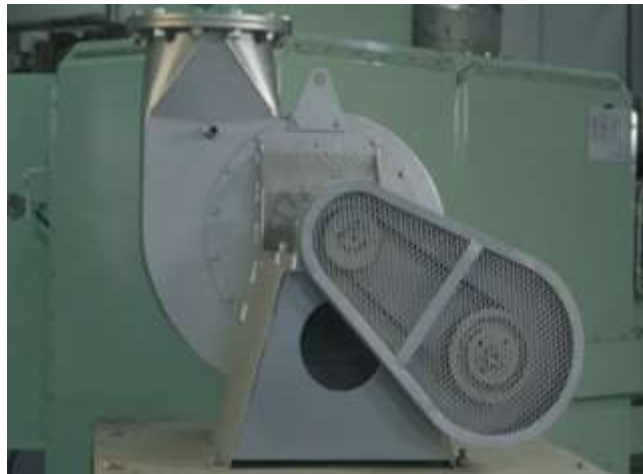
Gambar 2. 5 Flue Gas Fan
