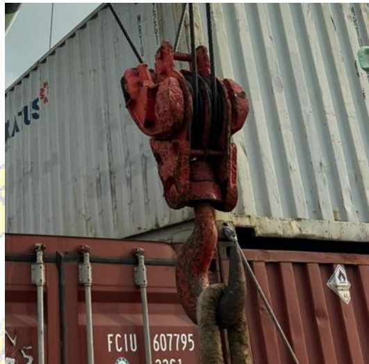
Gambar 2. 4 Blok pemuat Sumber: Dokumentasi pribadi
