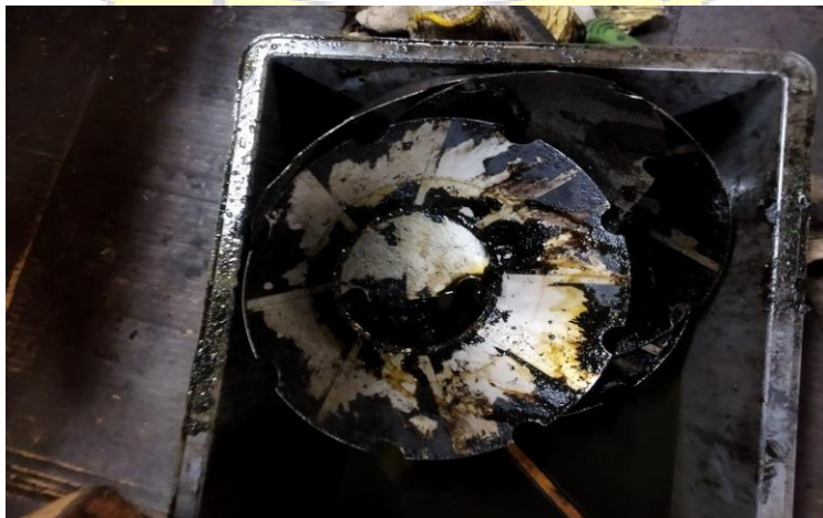
Gambar kerak pada disc purifier
