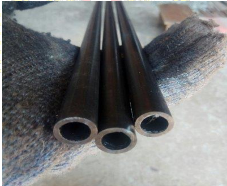
Gambar 2.8 fresh water pipe Sumber : dokumen pribadi
