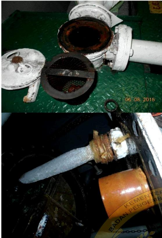
Gambar: 4.5 Pengecekan dan perawatan pada *sea chest*, *cooler*, dan *filter f.w cooling pump*.
