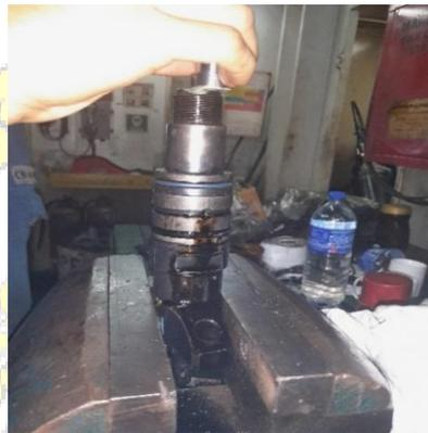
Gambar 2.5 Perbaikan Injector DG
