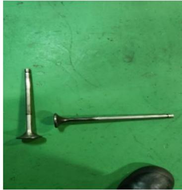
Gambar 2.1 Katup *in* dan *out* pada *cylinder head* DG
