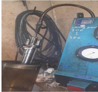
Gambar 2.6 Pengetesan *Injector*
