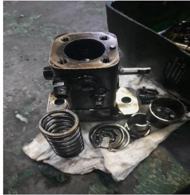
Gambar 2.8 Perbaikan *Booster Pump* Pada DG
