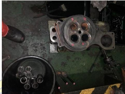
Gambar 2.7 Penggantian *Seating Valve* pada *Cylinder Head DG*
