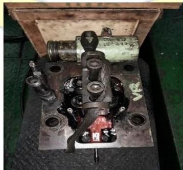
Gambar 2.2 Cylinder Head pada DG
