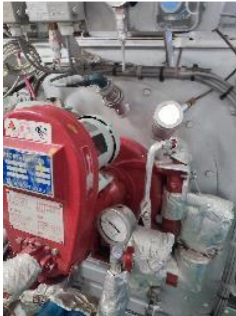
Gambar Pesawat Incinerator di Kapal MV. Federal Osaka
