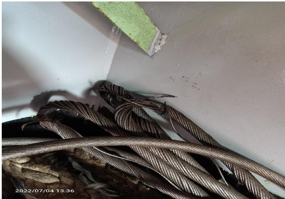
Lampiran 9 Kerusakan Crane wire MV.Meratus Pematang Siantar.
