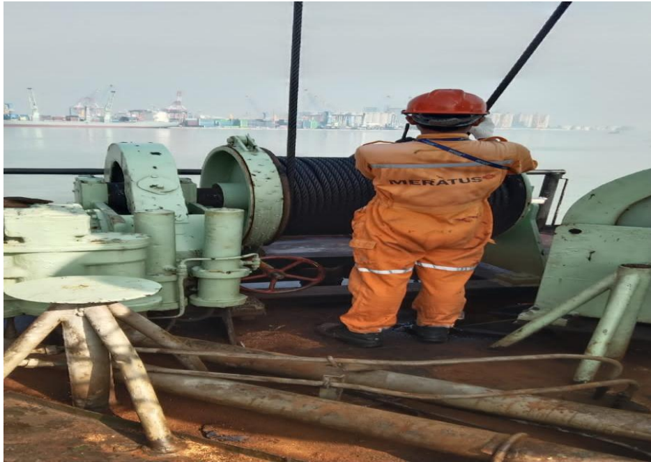
Lampiran 13 Pelumasan Crane wire menggunakan grease
