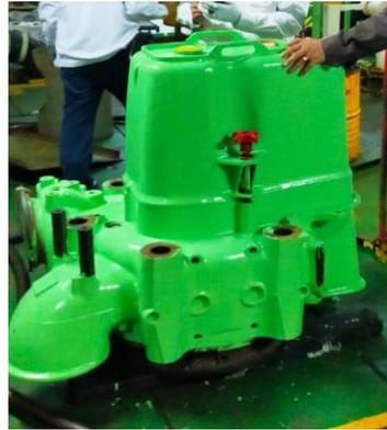
Gambar 2.2. *Cylinder head* mesin induk
