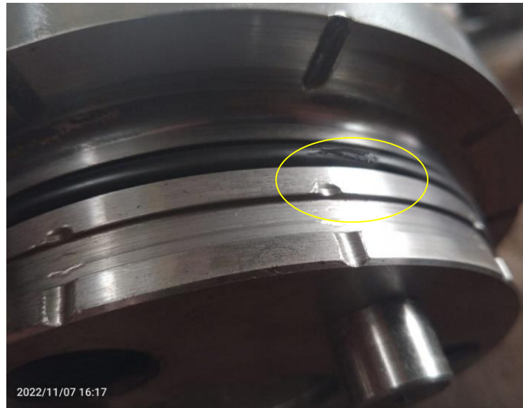
Gambar 3. Kerusakan pada O-ring seal pada crank disk
