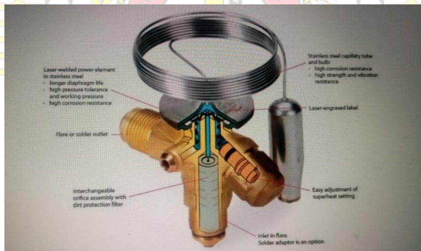
Gambar 2. 5 Katup ekspansi Sumber: Sumarlan et al. (2023)
