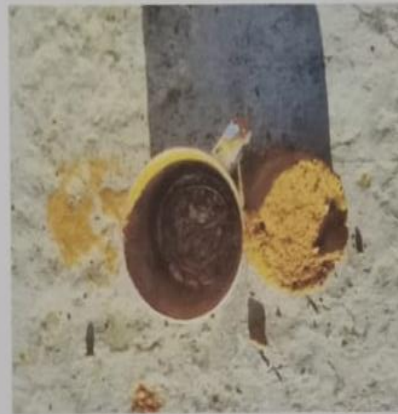
Gambar 4.7. Hasil Can Test yang Dapat Dimuat
