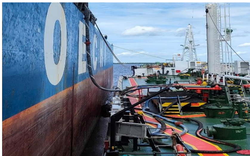
Gambar 2.3 Gambaran penggunaan cargo hose ketika STS pada MT. Karmila (Sumber : Dokumen pribadi, 2023)
