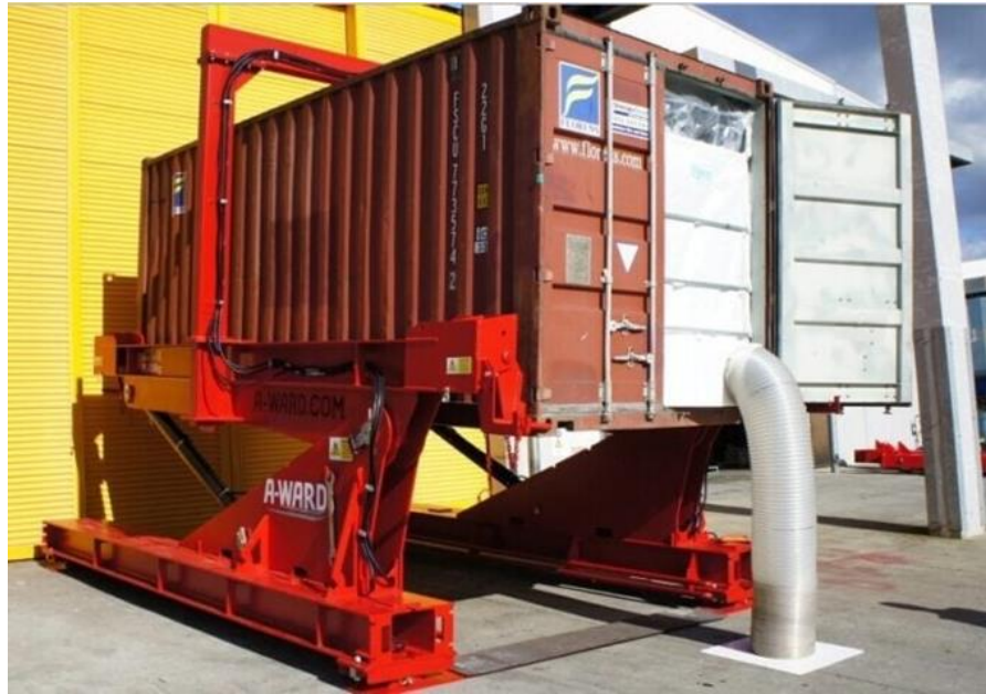
Gambar 2.4 Peti Kemas Curah Cair Sumber : aoitsubasa.jp
