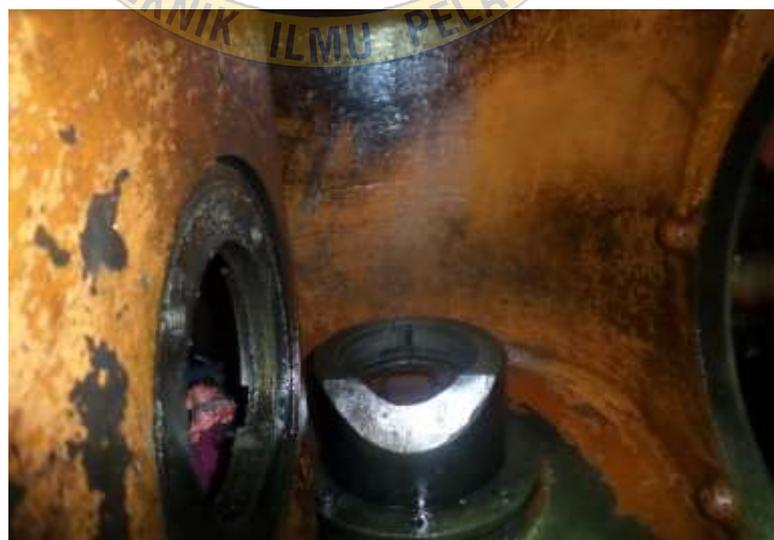
Gambar 4.8 *Bearing housing* yang kering akibat tidak adanya pelumasan
