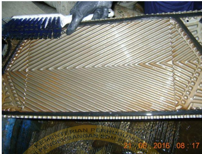
Proses Pembersihan Plat Evaporator Dan Condenser Menggunakan Brush
