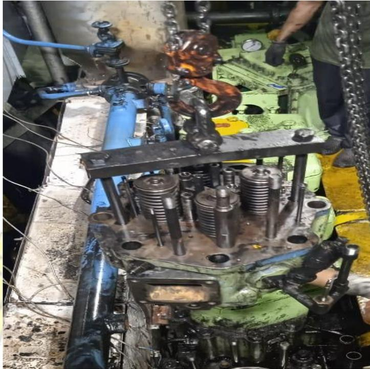
Gambar pelepasan *cylinder head* untuk pelepasan *Air Starting Valve*
