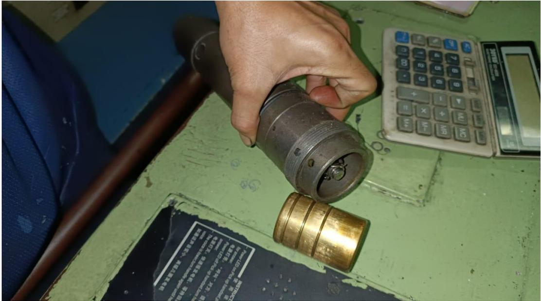
Gambar pelepasan *Plunger* untuk pembersihan dari kotoran
