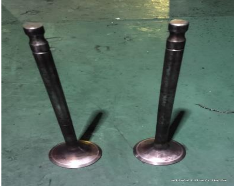
Valve yang sudah di lapping
