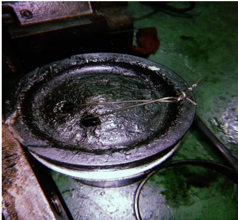
Piston yang rusak akibat spindle valve yang menancap
