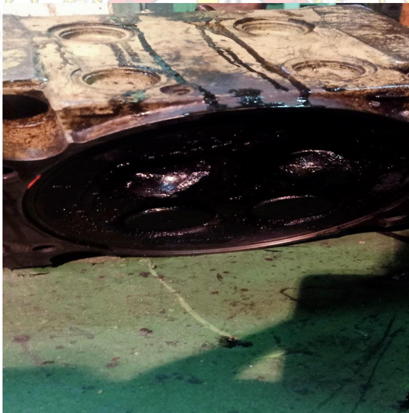
Seating valve yang rusak
