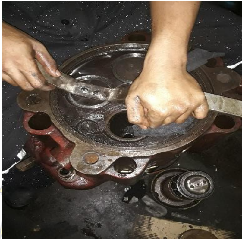
Melakukan lapping pada cylinder head
