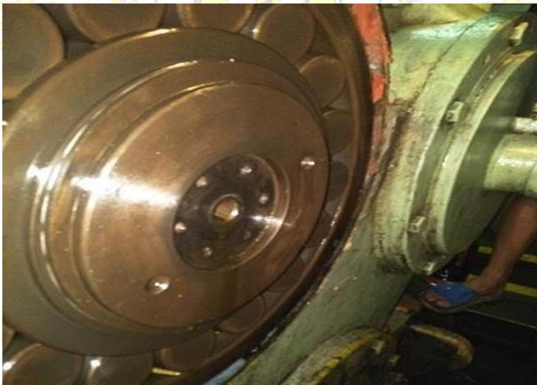
Lampiran 13. Bagian *Oil Filter Seat* dan *Sealing Ring* Yang Mengalami Keausan
