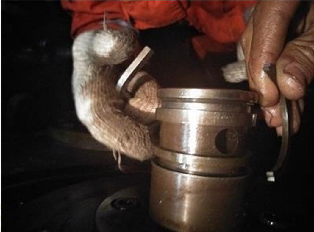
Lampiran 10. Perbaikan Pada *Sealing Ring Gearbox*
