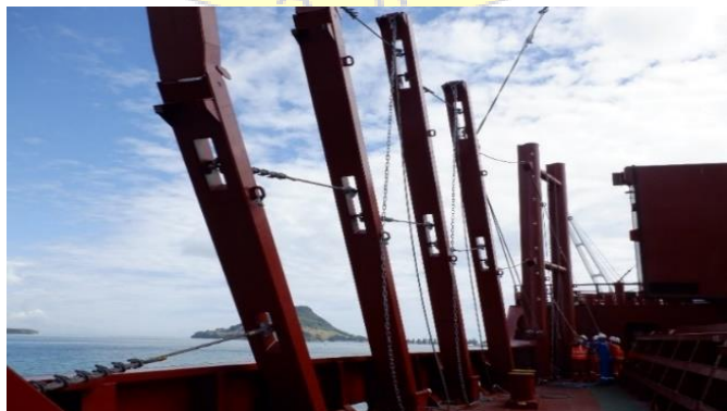
Gambar 2.4 Mendirikan Collapsible Stanchions Sumber: Dokumentasi MV. PAN OPTIMUM (2021)
