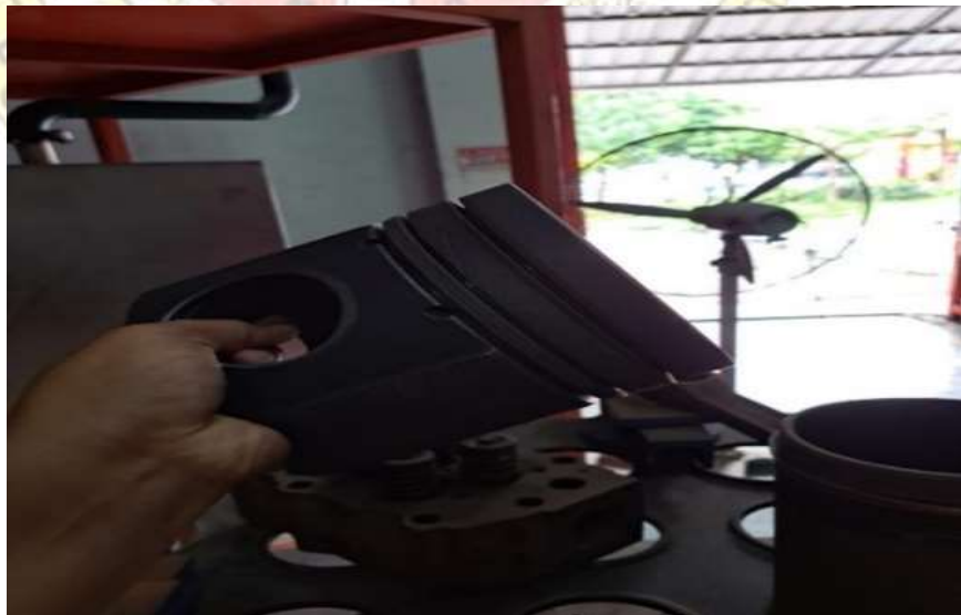
Gambar 2.3 Piston Generator Sumber: Dokumen Pribadi Di Olah, 2022
