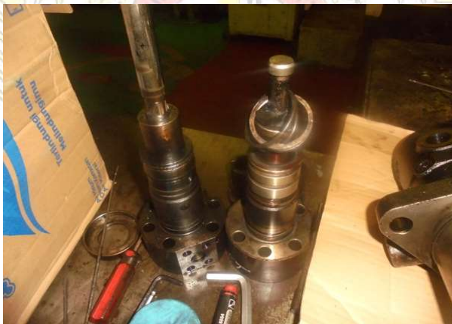
Keausan Pada Plunger Barel Fuel injection pump
