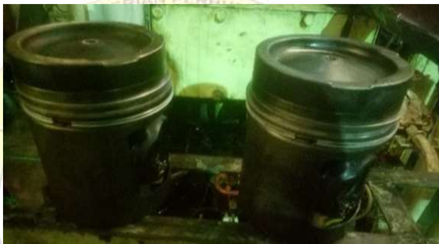
Gambar 2. 4 Ring Piston Generator Sumber: Dokumen Penelitian Di Olah, 2022
