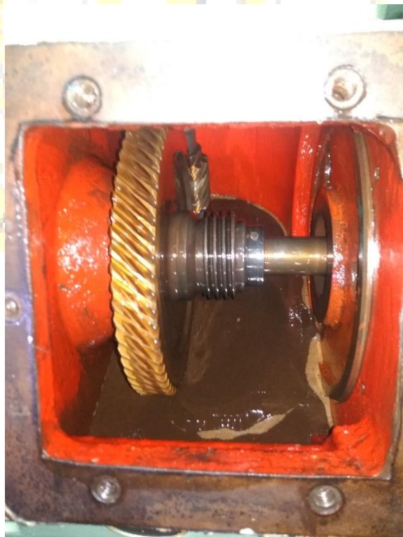
Gambar Spiral gear sebelum perbaikan
