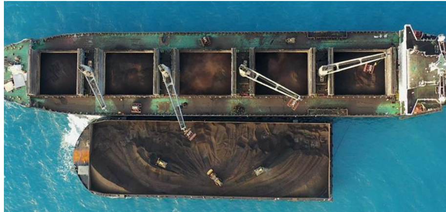
Gambar 2.1 Proses kegiatan transshipment di laut terbuka
